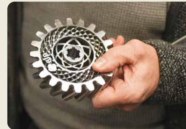
Hybridadditiv gefertigtes Metallbauteil in Leichtbauweise, bei dem das Laserschmelzverfahren als 3D-Druckverfahren mit dem Mikrofräsen in-situ kombiniert wurde.
