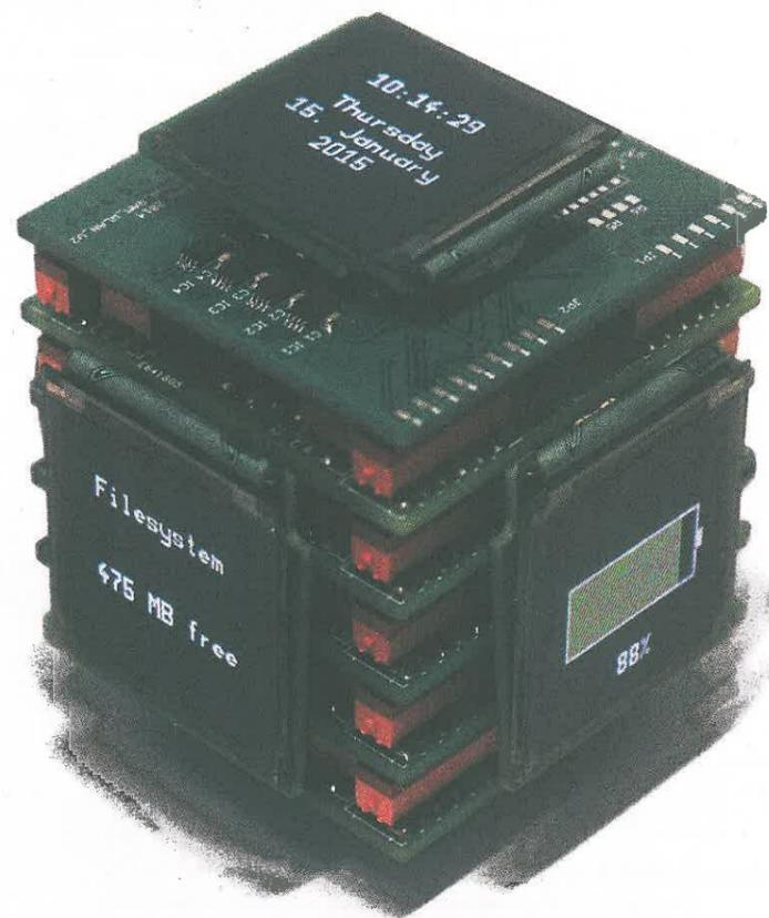
Ein neuartiger Ansatz zur Mensch-Maschine-Interaktion arbeitet mit einer würfelförmigen Benutzeroberfläche. Alle Seiten des Würfels bilden Displays, auf denen unterschiedliche Informationen dargestellt sind. Eingaben erfolgen nicht über die Touchtechnik, sondern Tippen auf eine Würfelseite. Lage beziehungsweise Drehung des Würfels detektieren MEMS-Beschleunigungssensoren. Das eröffnet ganz neue Möglichkeiten der Bedienung.
