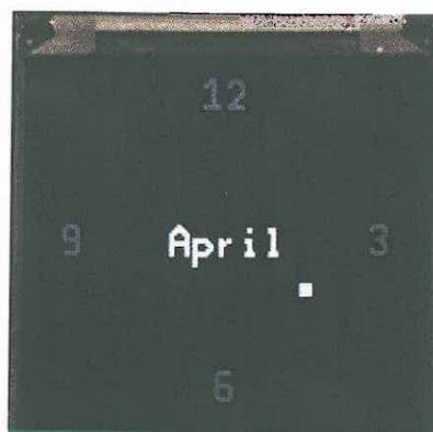
Bild 5: Monateinstellung mittels Analoguhrdarstellung – auf den Winkel des Cursors zum Mittelpunkt kommt's an
