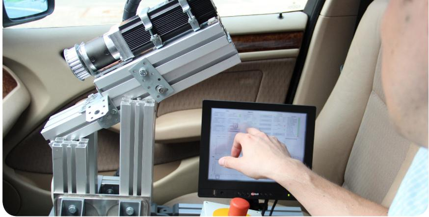
Innenansicht des Forschungsfahrzeuges mit eigens entwickelter Lenkaktorik
