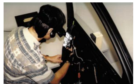
Augmented Reality zur Unterstützung von Service und Wartung (BMW).
