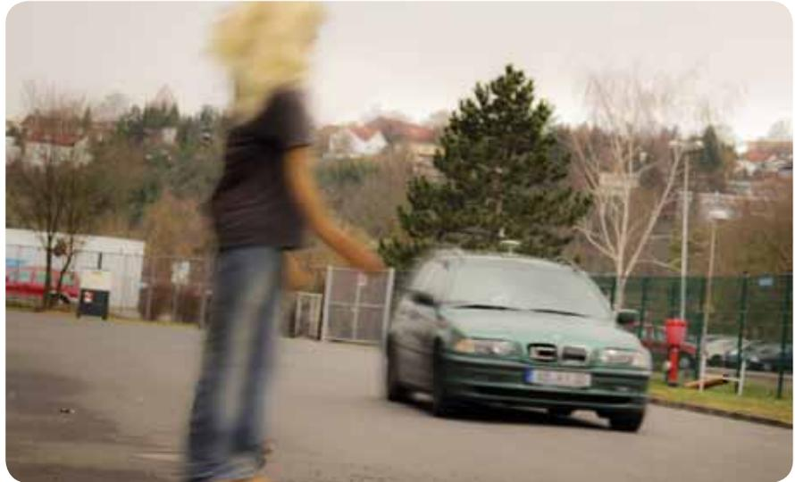
Nachbildung einer sicherheitskritischen Verkehrssituation unter Verwendung eines Fußgängerdummys
