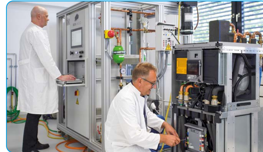
Prof. Dr.-Ing. Christian Steurer (links) mit Labormitarbeiter Andreas Neumann am Prüfstand für Wärmepumpen
